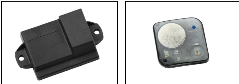
Immobilizer a frequenza **868 MHz** con due **transponder attivi a codice variabile**. Centralina e transponder sono sempre in allerta per entrare in contatto tra loro. Se la distanza non permette il dialogo, rimangono attivi i due blocchi motore sulla pompa di benzina e/o sul motorino di avviamento. In prossimità del veicolo, con il transponder in tasca, in borsa o nel portafogli, avviene il riconoscimento e i blocchi motore vengono disattivati per permettere l'accensione del veicolo.
