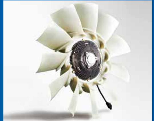
Sui motori dei veicoli industriali, per la dissipazione del calore sono necessari, oltre ai radiatori efficienti, anche ventole e relativi azionamenti, che approntano l'aria di raffreddamento in modo particolarmente efficiente. Il ventilatore è composto da una ventola e da una frizione. Le frizioni sono impiegate sui motori montati in posizione longitudinale e vengono installate in direzione di marcia a monte del radiatore.
